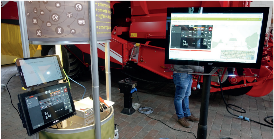
Bild 25: Smart-Farming-Installation am Teststand – links oben: Smart Terminal, darunter Maschinen-ISObus-Terminal, Mitte: Kommunikationsmodul, rechts: Plattform mit Teleservice-„App“
