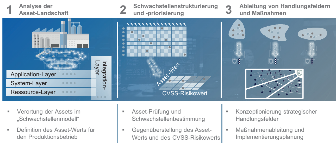
Bild 2: MHP- und FIR-Methodik zur Identifikation von Cybersicherheitschwachstellen in der Produktion (eigene Darstellung)
